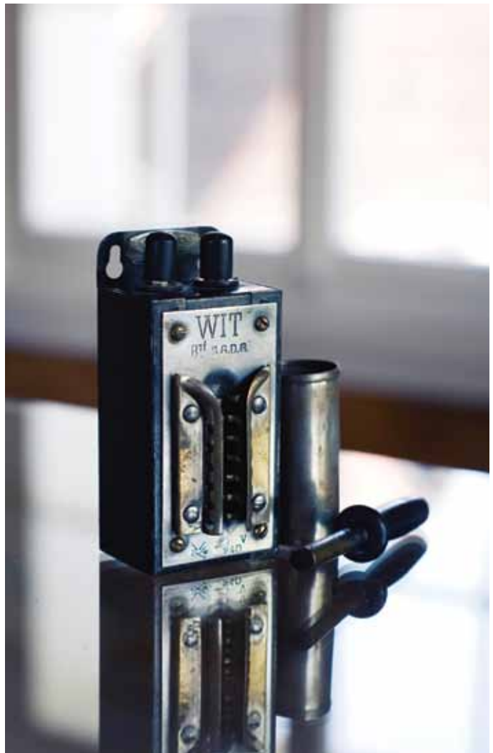
Dieses Feuerzeug wurde in Stromkreise eingebaut und erzeugte die Flamme per Kurzschluss
